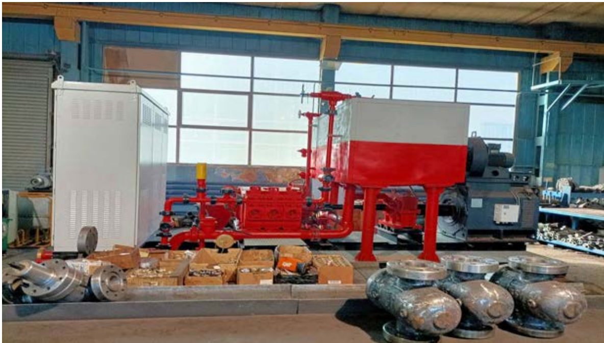
Fig 2.3- Instalatie de cimentare ansamblu
