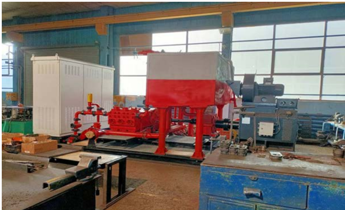
Fig .2- Instalatie de cimentare ansamblu vedere laterala
