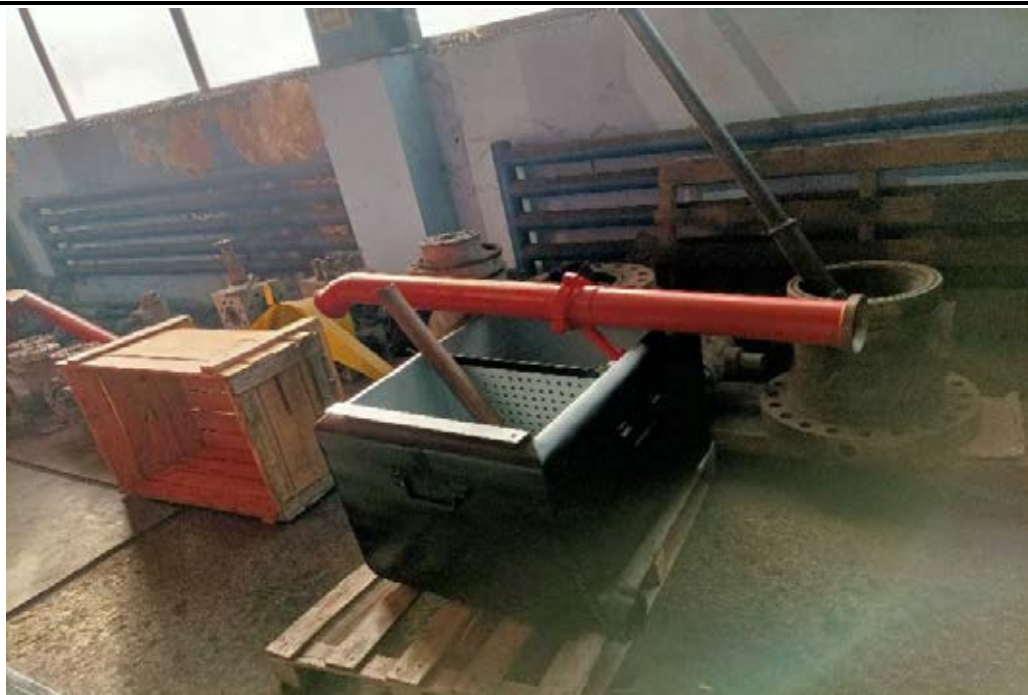
Fig. 2.2. i Ansamblu instalatie de cimentare- Rezervor masurare
