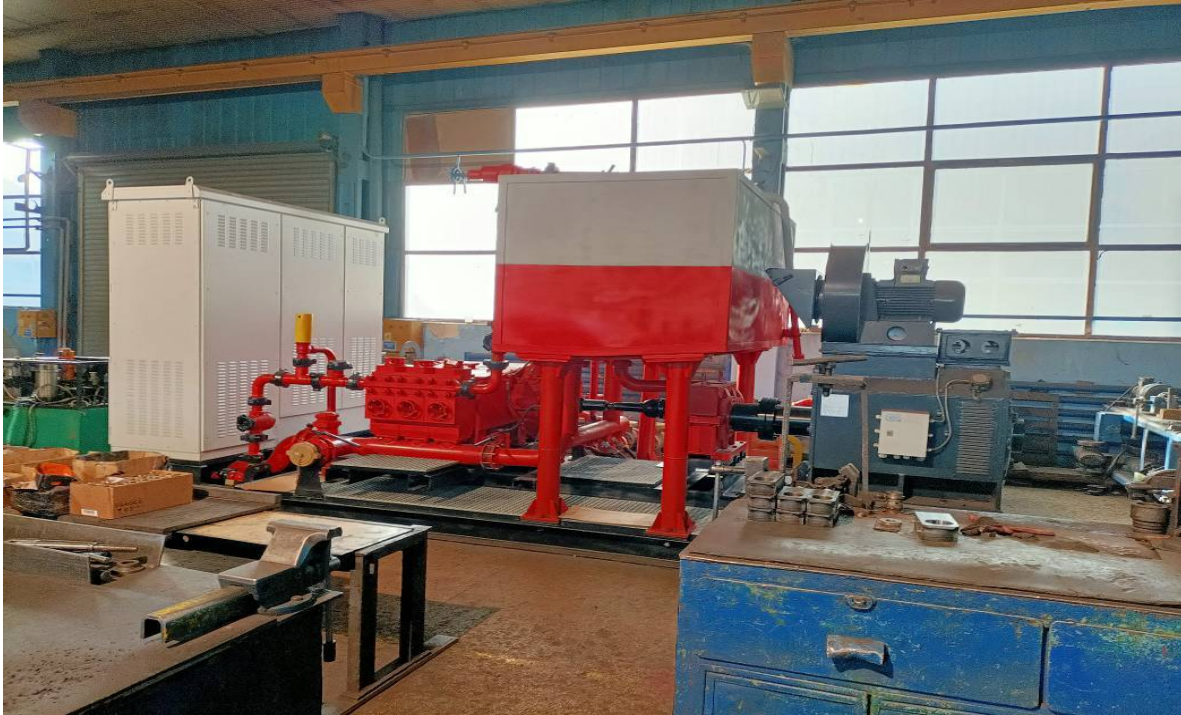
Fig .2- Instalatie de cimentare ansamblu vedere laterala
