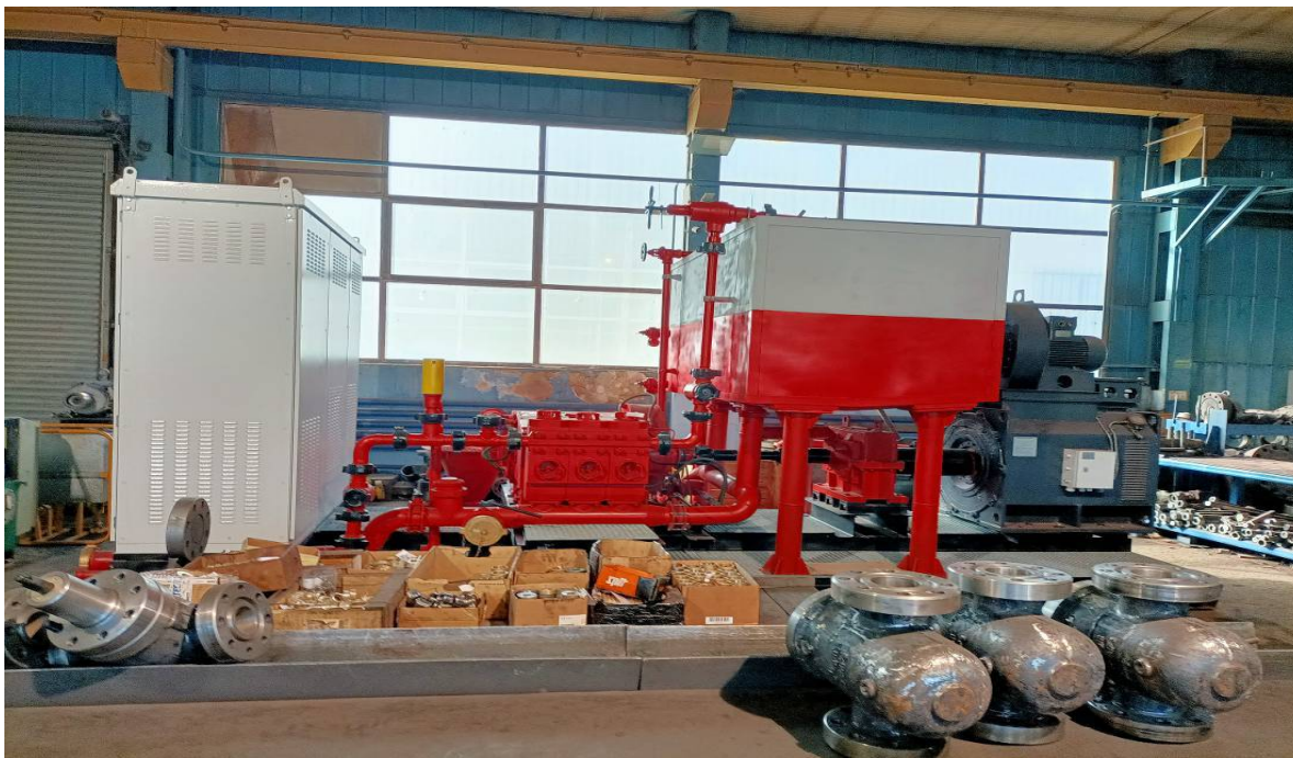
Fig 2.3- Instalatie de cimentare ansamblu
