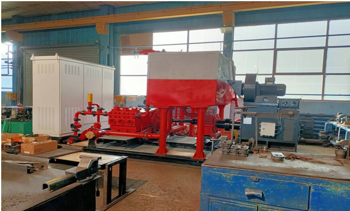
Fig 2.2- Instalatie de cimentare ansamblu vedere laterala
