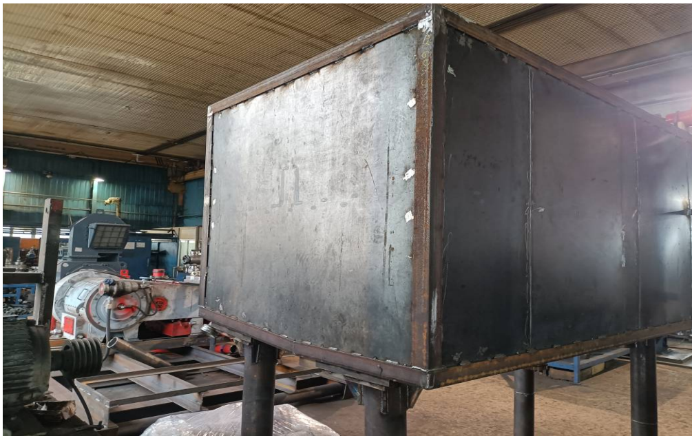
Fig. 1.11. i Ansamblu instalatie de cimentare- Rezervor masurare
