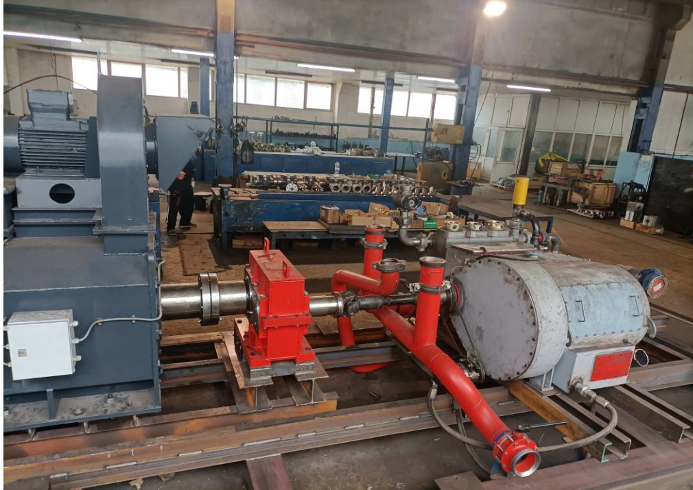
Fig. 1.11. a Ansamblu instalatie de cimentare - INOCEM 00-00.00.00.0
