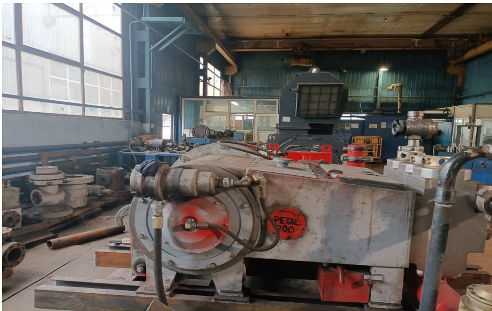
Fig. 1.11. g Ansamblu instalatie de cimentare- pompa triplex cu plungere
