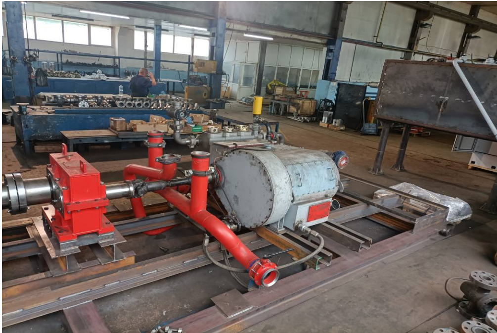
Fig. 1.11. f Ansamblu instalatie de cimentare- pompa triplex cu plungere
