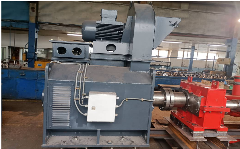
Fig. 1.11. b Ansamblu instalatie de cimentare – motor electric asincron
