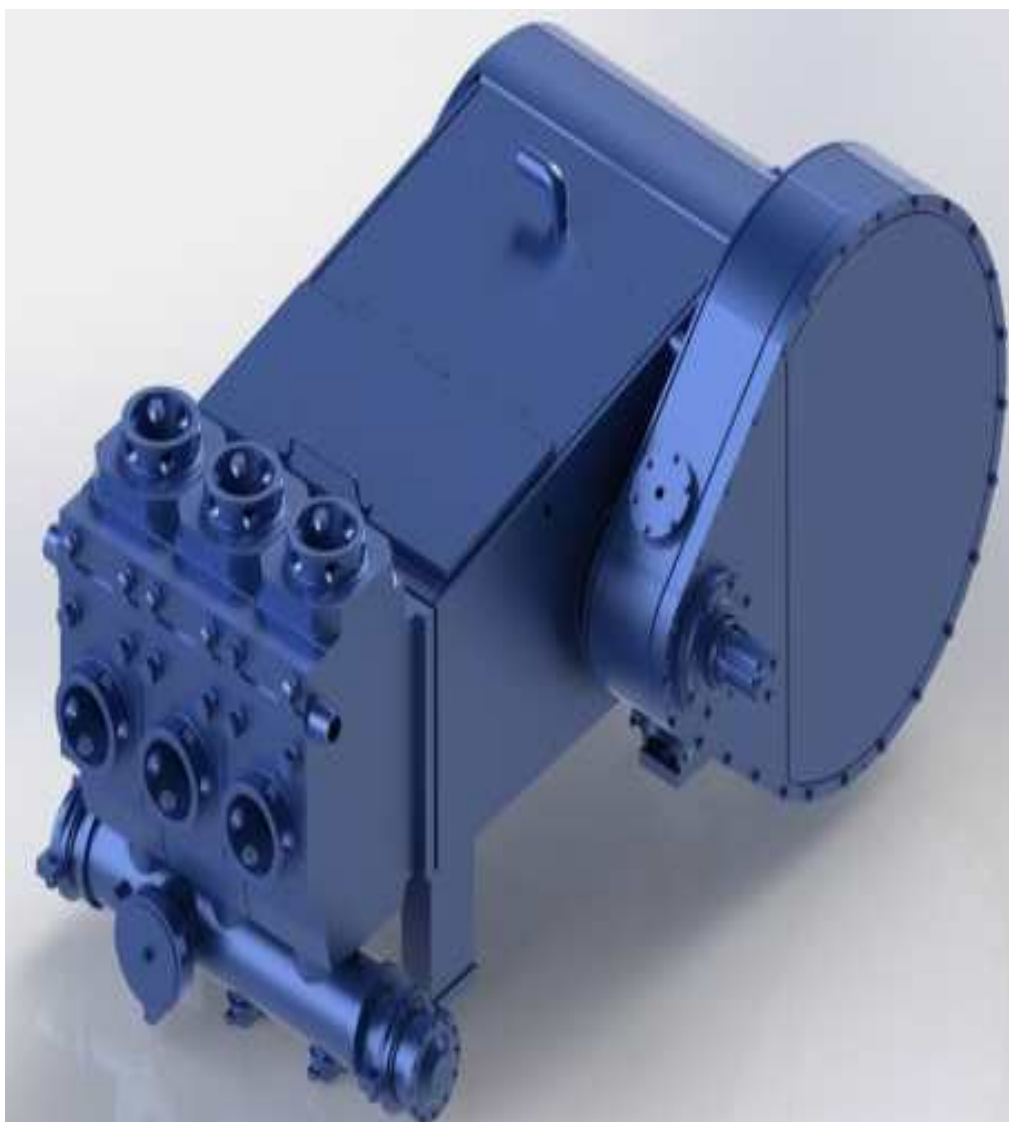
Fig. 1. Pompa triplex din Instalația inovatoare pentru cimentare și operațiuni speciale la sondă
