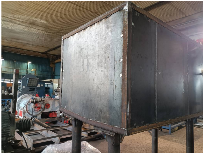
Fig. 1.11. i Ansamblu instalatie de cimentare- Rezervor masurare
