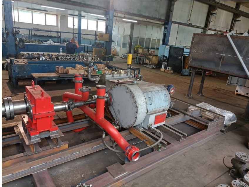
Fig. 1.11. f Ansamblu instalatie de cimentare- pompa triplex cu plungere
