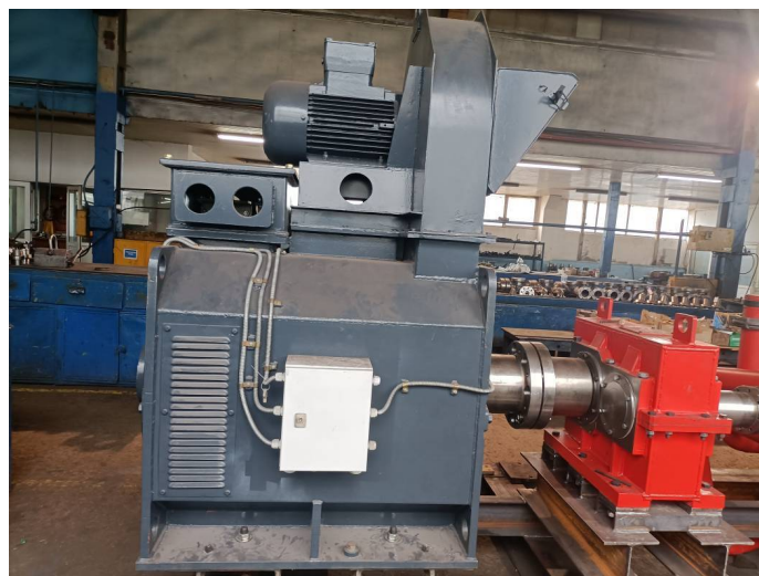
Fig. 1.11. b Ansamblu instalatie de cimentare – motor electric asincron
