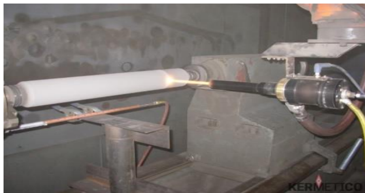
Fig. 8. Procedeu de depunere HVAF prin pulverizare a carburii de wolfram pe un plunger de pompa [76]
