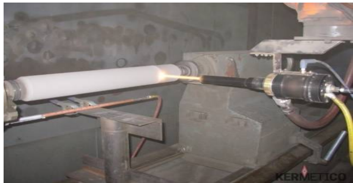
Fig. 8. Procedeu de depunere HVOF prin pulverizare a carburii de wolfram pe un plunger de pompa [76]
