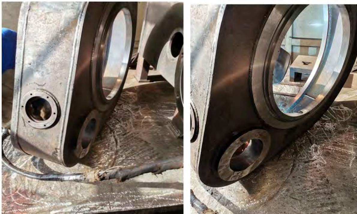
b). Prelucrări mecanice și de sudură pentru Corp Frema de test
