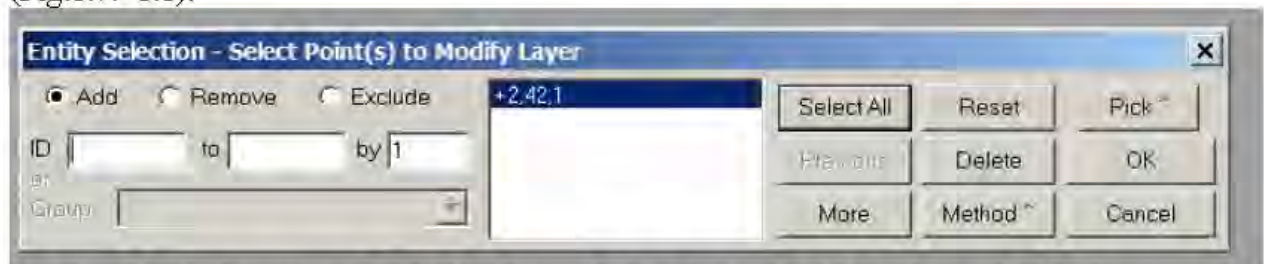
Fig.8.7. Folosirea comenzii Modify / Layer / Point, Select All și Select Layer, indicându-se noul Layer 9.W12X35 în care or să fie introduse elementele geometrice, pentru punctele secțiunii profilului W12X35
